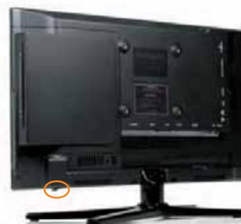
Durch den integrierten Ein-/Ausschalter an der Unterseite kann das Gerät vollständig von der Stromversorgung getrennt werden. Die ohnehin geringe Standby-Stromaufnahme wird dann auf 0 reduziert, die LED auf der Frontblende abgeschaltet.
