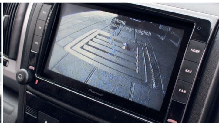
Mit der CS105ULA Unterbodenkamera erkennt man sämtliche Abläufe und kann das Reisemobil perfekt über einem Bodeneinlass positionieren.
