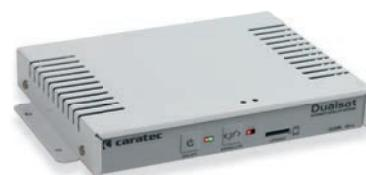
Updates per MicroSD-Karte: Sollte eines Tages mal ein Update erforderlich sein, ist dies leicht über das Steuergerät per MicroSD-Karte möglich.
