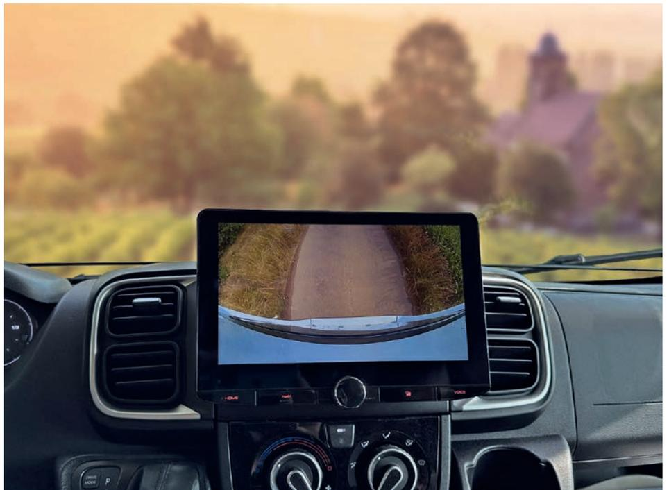
Mit Caratec Kameras lässt sich sicher rangieren: Hindernisse hinter dem Fahrzeug werden zuverlässig angezeigt. Ob auf einem separaten Monitor oder dem integrierten Display von Moniceiver oder Navi, entscheiden Sie.
