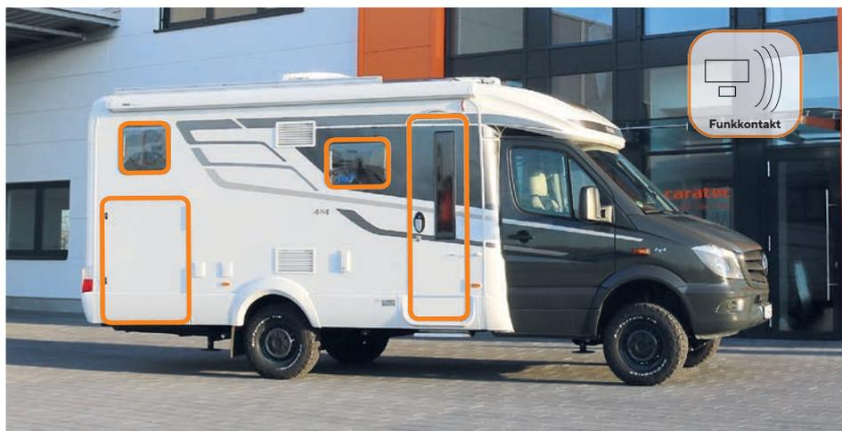
Zusätzlicher Schutz: Mit den optionalen Funksensoren lassen sich Klappen, Fenster oder Aufbau Türen sichern.
