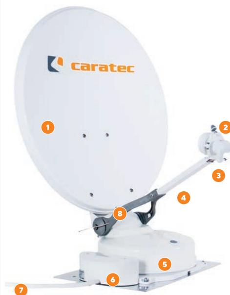
① Spiegel aus Aluminium mit UV-geschützter Pulverbeschichtung ② LNB-Befestigung aus langzeitstabilem ASA-Kunststoff ③ Vorbereitung für Twin LNB ④ LNB-Arm aus rechteckigem Alurohr ⑤ Abdeckung aus langzeitstabilem ASA-Kunststoff ⑥ Anschlussbox, Leitungen der Dacheinheit sind abnehmbar ⑦ Alle Anschlüsse in nur einer Leitung zusammengefasst ⑧ Alu-Druckguss mit Anti-Korrosions-Beschichtung
