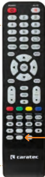
Sat-Antenne auf einen Klick ausfahren
