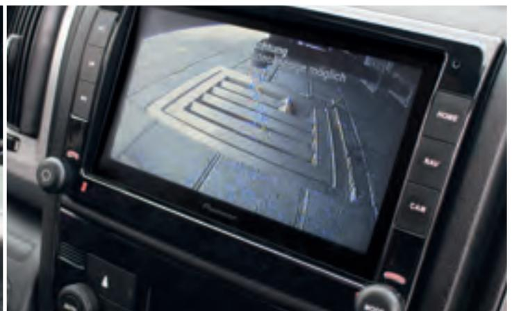
Mit der CS105ULA Unterbodenkamera hat man die Abläufe im Blick und kann das Reisemobil perfekt über einem Bodeneinlass positionieren.
