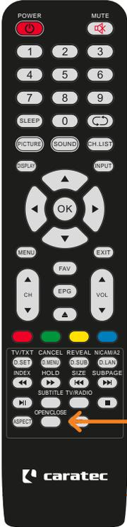
Sat-Antenne auf einen Klick ausfahren
