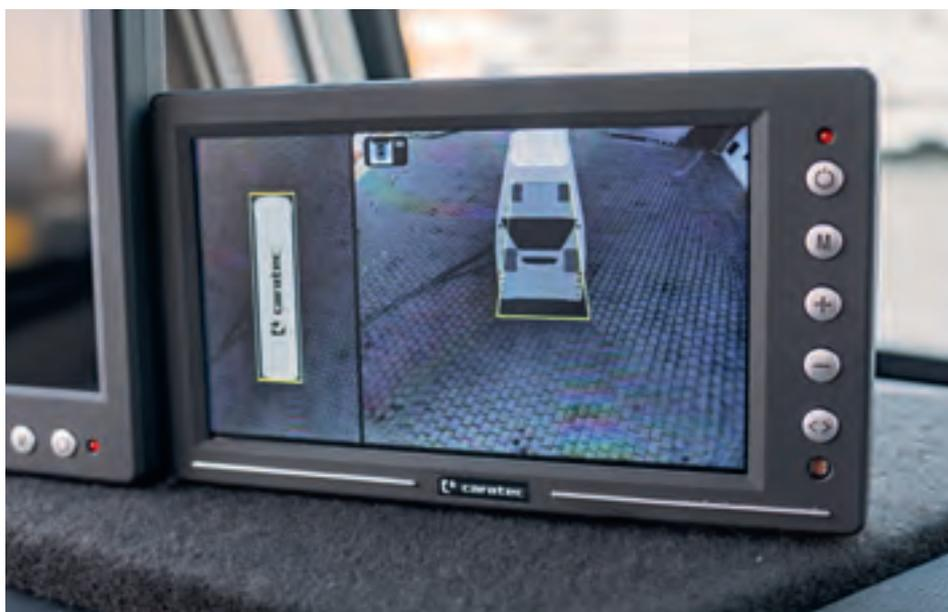
Das 3D HD Birdview-System zeigt bei langsamer Fahrt gleichzeitig die Ansicht des Fahrzeugmodells von hinten und eine Draufsicht. So haben Sie alles im Blick.
