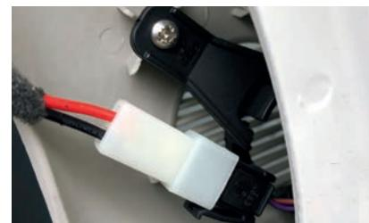
Einfacher Anschluss mit Steckverbinder
