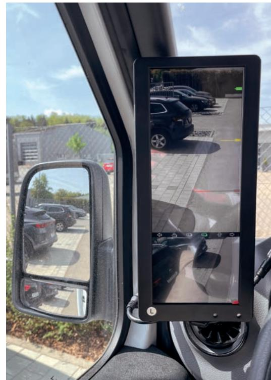
Im Vergleich zum herkömmlichen Rückspiegel zeigt das Kamerasytem deutlich mehr an.
