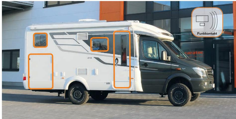
Zusätzlicher Schutz: Mit den optionalen Funksensoren lassen sich Klappen, Fenster oder Aufbautüren sichern.
