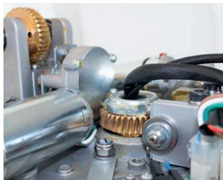
① Platine für die Steckverbinder ② Starke Motoren mit integriertem Hallgeber und gekapseltem Getriebe ③ Stabile Drehplatte aus Aluminium-Druckguss ④ Leitungen mit zusätzlichem Scheuerschutz ⑤ Pulverbeschichtete Grundplatte aus Aluminium-Druckguss ⑥ Solide Getriebe mit Messing-Zahnrädern und Kugellagern, Schrägerverzahnung für wenig Spiel
