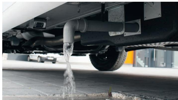
Mit der CS105ULA Unterbodenkamera erkennt man sämtliche Abläufe und kann das Reisemobil perfekt über einem Bodeneinlass positionieren.
