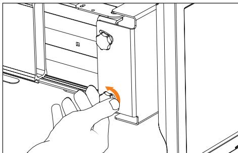
Zum Neigen des **Halters** müssen Sie zuerst die beiden **Kunststoffschrauben** an der **Halteplatte** etwas lösen.
