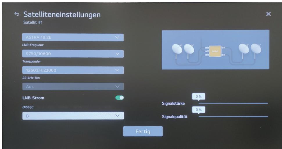
Die SAT-Antenne sollte sich nun bewegen und auf Astra 19.2 ausrichten. Sollte sich die Antenne nicht ausrichten, kontrollieren Sie bitte ob die Antenne eingeschaltet und ausgefahren ist.
