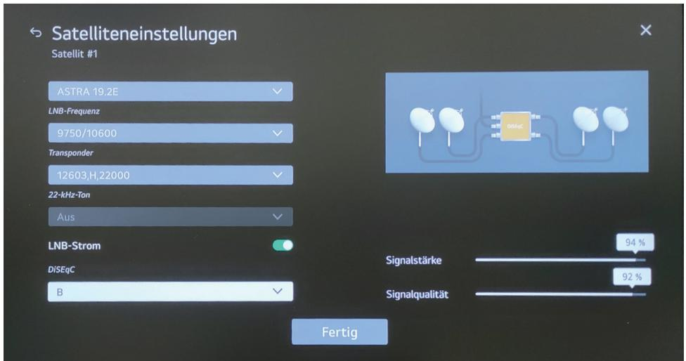
Warten Sie bis sich die SAT-Antenne ausgerichtet hat und in den Standby-Modus gewechselt ist. Rechts können Sie über die Anzeige der Signalstärke und Qualität überprüfen, ob die Antenne ausgerichtet ist. Anschließend wählen Sie „Fertig“.
