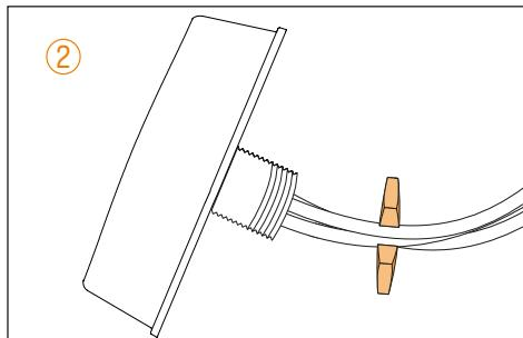
Bohren Sie ein Loch mit ausreichend großem Durchmesser, um die Kabel und das Gewinde der Antenne durch das Fahrzeugdach zu führen. Reinigen Sie den Bereich um die Bohrung gründlich.
