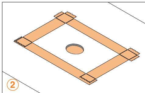
Markieren Sie sich mit **lösbaren Klebstreifen** den Bereich, an dem die **Dachdurchführung** aufgesetzt werden soll.
