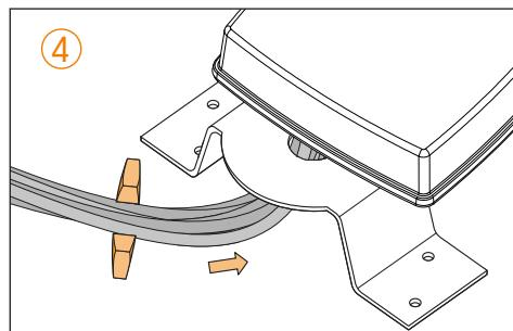
Führen Sie die sechs **Antennenleitungen** von oben durch das Loch der **Antennenhalterung**.
