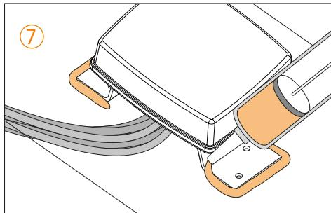
Entfernen Sie das Klebeband und tragen Sie zur Abdichtung rund um die **Halterung** sowie auf den Befestigungsschrauben bzw. den Schraublöchern eine Kleberaupe auf.
