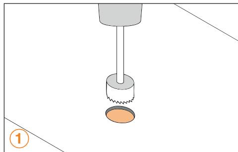
Bohren Sie mittig an der für die **Dachdurchführung** vorgesehenen Stelle ein Loch. Entgraten Sie das Bohrloch mit Schleifpapier und schützen Sie die Schnittkante gegen Korrosion.
