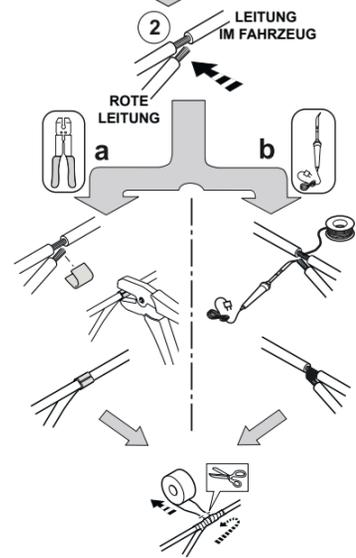
Für eine sichere Verbindung empfehlen wir die Leitungen zu verkrimpen oder zu verlöten. Bitte isolieren Sie die Leitungen anschließend.
