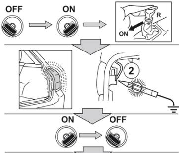
Schalten Sie die Zündung ein und legen Sie den Rückwärtsgang ein um das Rückfahrtsignal (z.B. mit einer Prüflampe) im Fahrzeug ausfindig zu machen.
