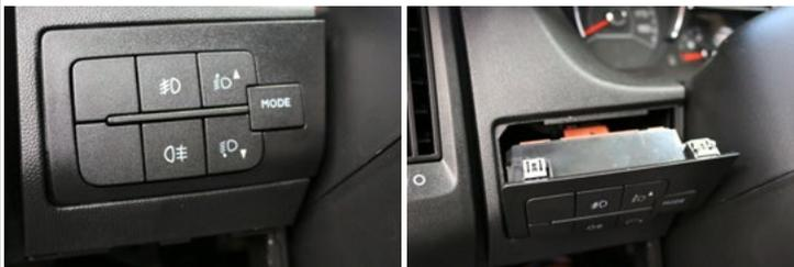
2. Tastenpanel durch entriegeln der 4 Rastnasen aus der Verkleidung lösen.
