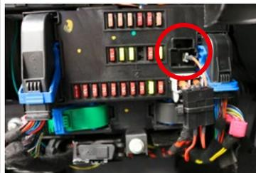
3. Sicherungshalter mit Kabelbinder befestigen.
