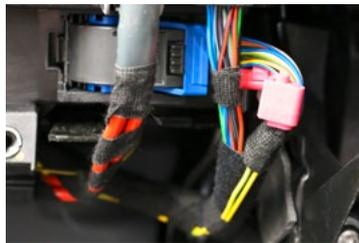
4. Leitungssatz einbinden und Kabelbinder am Steuergerätestecker anbringen.
