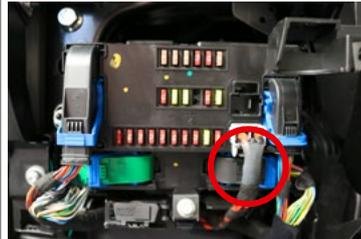
2. Kabelbinder entfernen, Leitungssatz ggf. freilegen.
