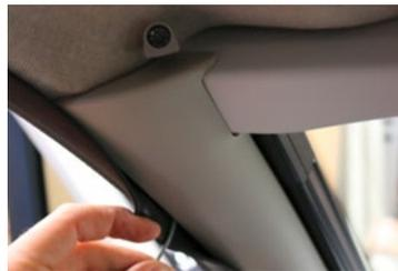
4. Beide Leitungen an der linken A-Säule nach unten ins Armaturenbrett verlegen.
